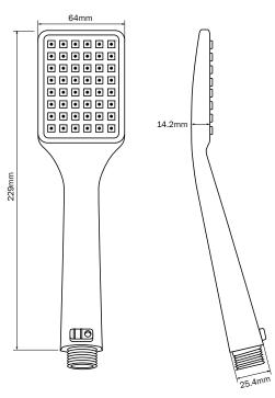
本電熱水器GPU-6SSL必須使用德國寶專用慳 水節能花灑頭。
