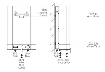
**使用外碼時注意:**確定爐的安裝位置後,請先用螺絲將外碼固定在牆上,再將爐後蓋上的方孔對準固定在牆上的外碼,向下將爐穩靠地固定掛在牆上。
