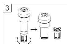
將內壺底部的過濾杯向左(順時針)旋 轉拆出。
