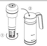
將過濾杯向右(逆時針)旋轉裝回內 壺。如有需要,可加入冰塊在內壺裡。 再將主機及內壺穩固地裝回外壺。 6
