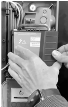
步骤 1 打开电子组件盖面
