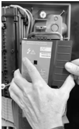
步骤 5 装回电子组件盖面，适配器 安装完成
