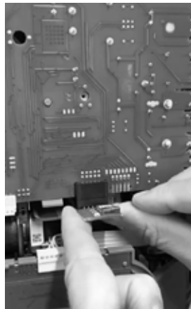
步骤 3 稳妥插入适配器 (注意连接器的正确位置)
