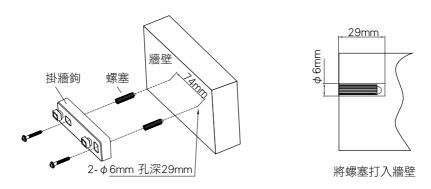
③ 安裝機器:把掛牆方孔(大孔)對準掛牆鈎,然後右移至小孔。
