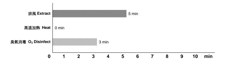
「臭氧+高溫」模式流程圖 "Disinfection & Heating" Mode
