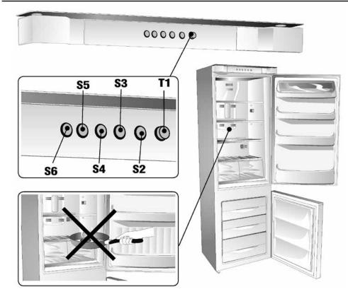
溫度設定及控制:可選擇3種不同溫度,綠色LED燈(S2-S3-S4)顯示選擇溫度。更改溫度時,按下 T1按鈕,每次按下後亮著的LED燈熄滅,下一指示燈閃爍4秒,順序為S2-S3-S4-S5。
