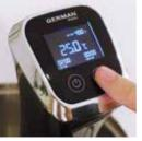
3.1 設定鍵 (票):按一次設定"小時",按兩次設定"分鐘",再按 兩次設定溫度。時間/溫度顯示閃爍時,可通過滑動滾輪調節時 間/溫度。除設定時間閃爍時外,任何時候都可調節設定溫度。
