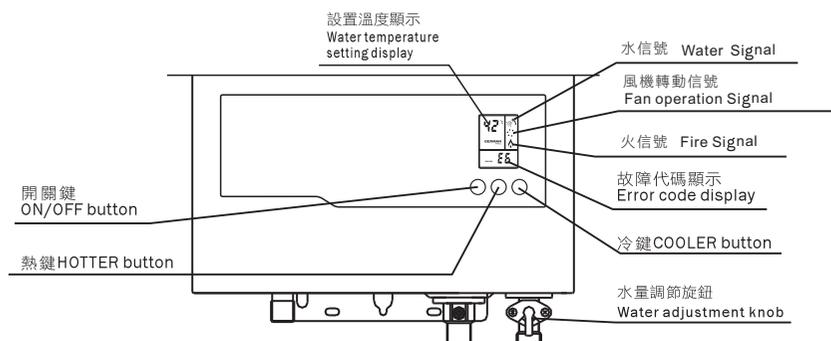
如出水溫度始終達不到設置溫度，則可適當調節“水量調節旋鈕”，以使出水溫度達到設定溫度，順時針調節水量減少，逆時針調節水量增大。
