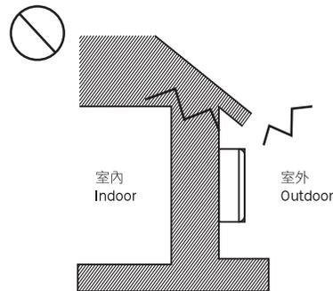
不正常燃燒可能導致生火或熱水器被雨水破壞。
